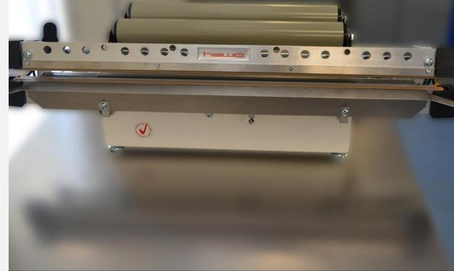
O intervalo de temperaturas de selagem a ser utilizado deve ser determinado tendo como base a informação disponibilizada quer pelo fabricante do sistema de barreira estéril pré-formado, quer pelo fabricante do equipamento.
